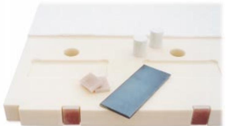
Lavorazione della lastra di schiuma con macchina CN. Gli inserti di ferro, alluminio, resina, nylon, PVC ecc. sono collocati con estrema precisione.
